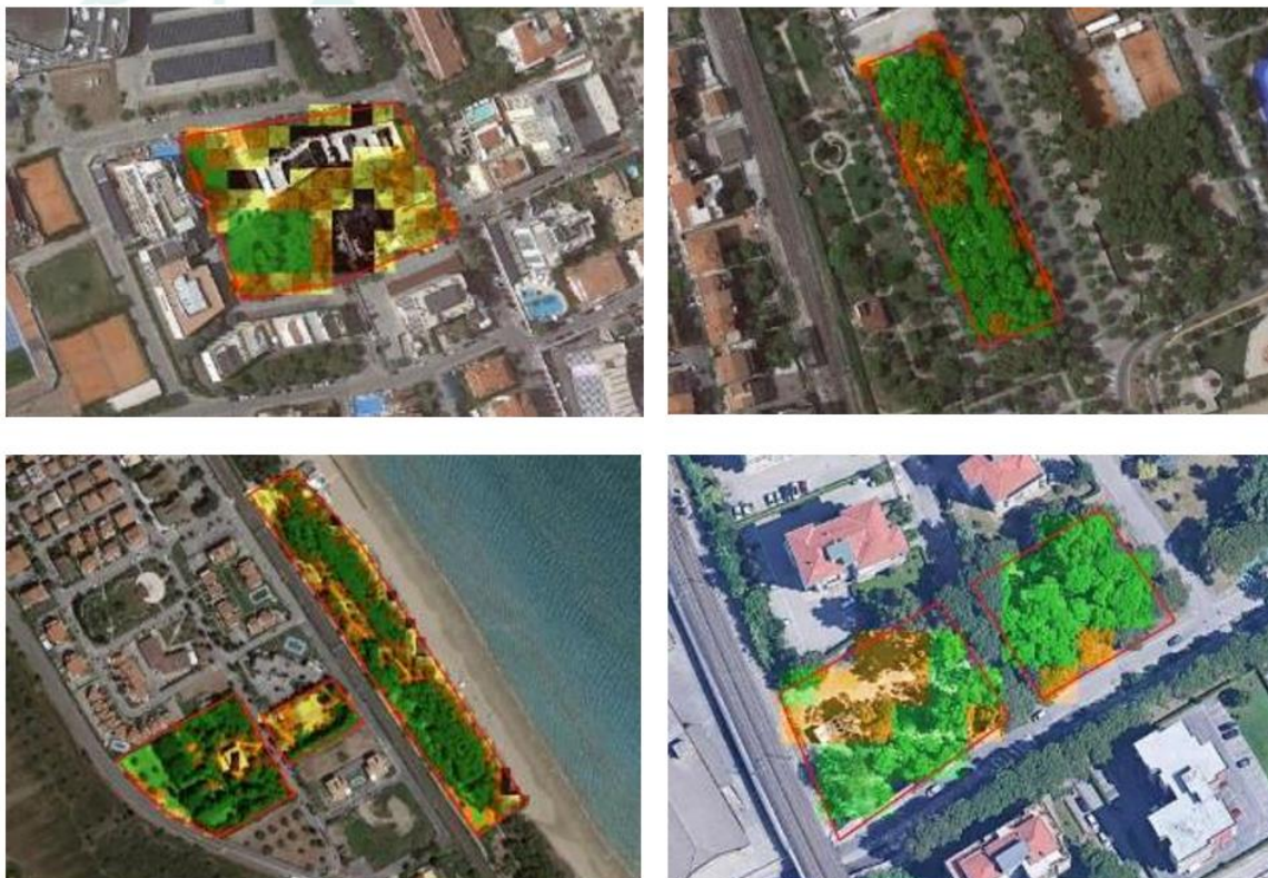
fig.25 Esempi di sovrapposizione dell'indice SAVI alle aree campione
