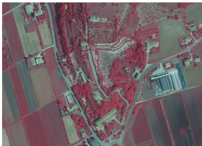
fig.5 Esempio di False Color Composite
