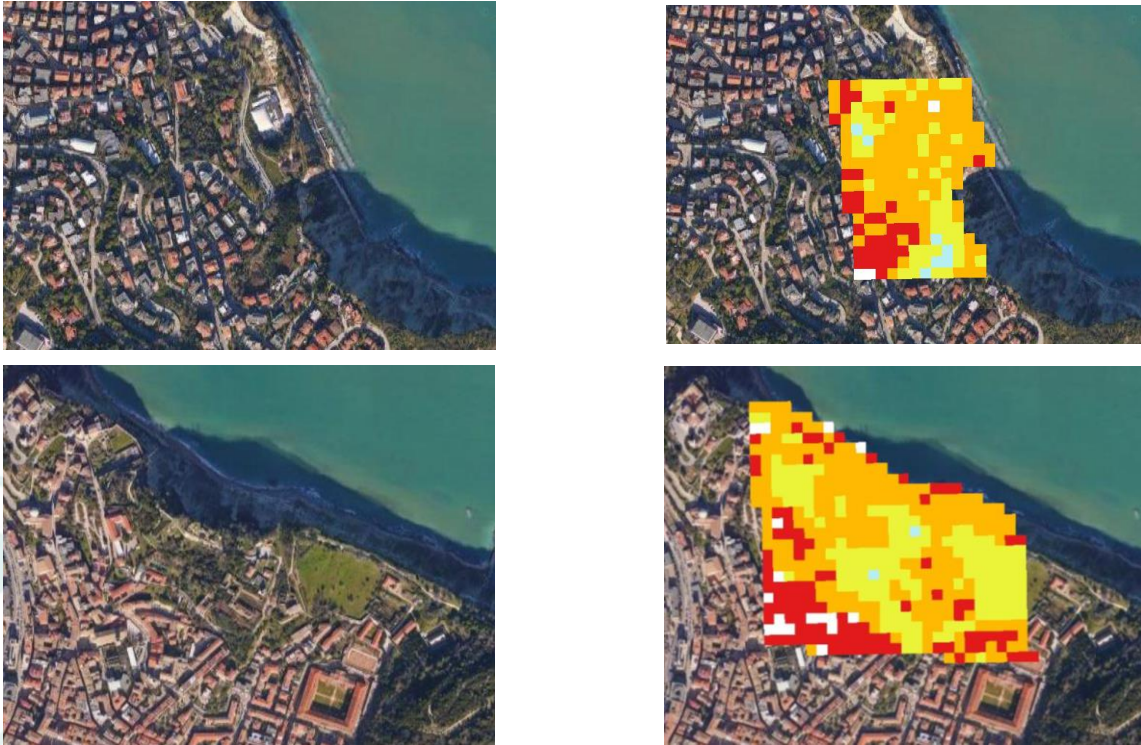
fig.36 Focus su alcune delle aree pilota del progetto con la diversificazione dell'indice NDMI
